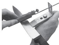
Die beste Schleifmethode ist, mit Punkt A anzufangen und zu Punkt B mit nur soviel Druck zu streichen, daß der Stein schleift. Heben Sie den Schleifstein zu Punkt C. Schleifen Sie von C zu D, heben Sie dann den Schleifstein zu Punkt E usw. (siehe Zeichnung). Halten Sie den Führungsstab am Boden des Winkelloches. Drehen Sie das Messer und die Klemme um und wiederholen Sie das Ganze, indem Sie den gleichen Winkel benutzen, den Sie auf der ersten Seite der Schnide benutzt haben.
