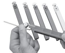
Verifiez l'alignement des deux parties en les couchant sur une surface plane pour vous assurer que la base et la tige de guidage touche la surface sur toute leur longueur. Is la tige de guidage n'est pas alignée avec la pierre, la plier légèrement utilisant la pression des doigts.
